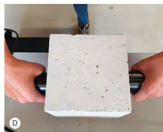
D. Ultrasonics Pulse Velocity (Pundit PL200)
