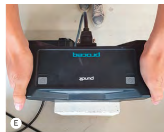
E. Ultrasonics Pulse Echo (Pundit PL200PE)
