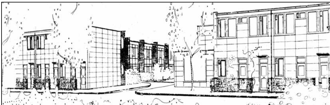
Afbeelding 4.4.117: een perspectieftekening van het plan in de ontwerpfasen. De plaatverdeling van de gevels is een wezenlijk element in het ontwerp en zou volgens het plan van de Werkplaats voor Architectuur dan ook behouden blijven. Mulder, J., 'Frankendaal', Publieke Werken , (1950)1, pp. 12-15.
