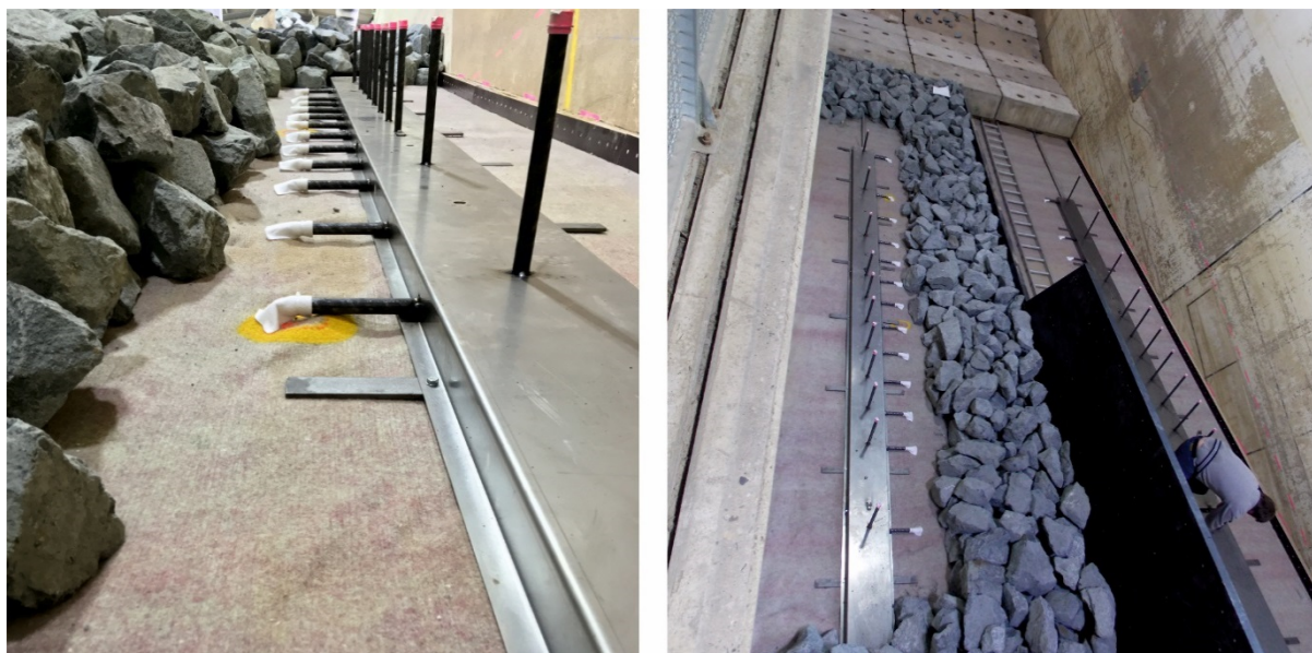
Abbildung 13: Druckmessdosenkanal in der Deckschicht (Fotos: Kreyenschulte 2017).
