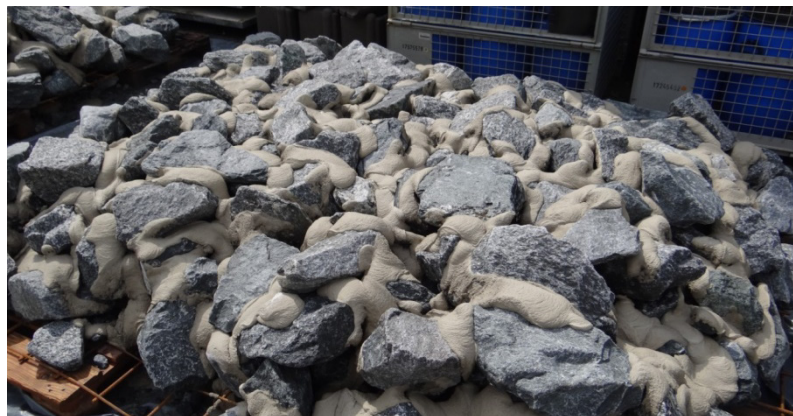
Abbildung 24: Versuchsdeckschicht am IWW (Foto: Kreyenschulte 2016).
