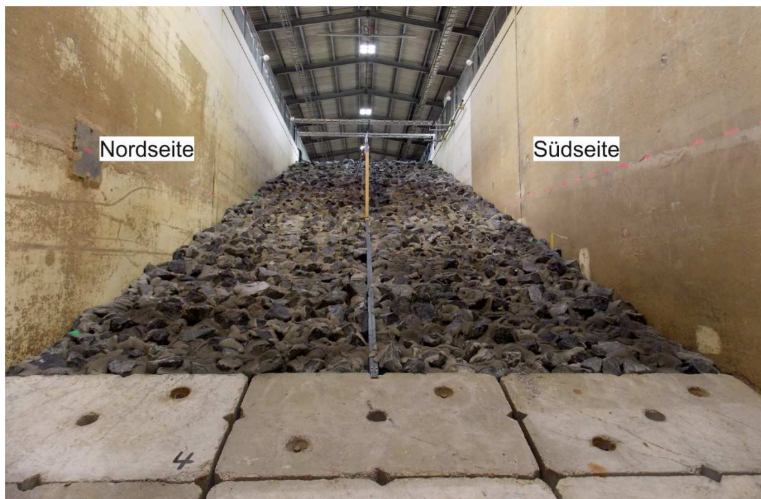
Abbildung 9: Teilvergossene Deckschichten in Versuchsphase 1 (Foto: Kühling 2017).
