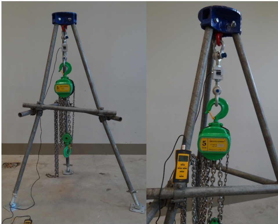
Abbildung 23: Versuchseinrichtung für Ausreißversuche (Fotos: Flegelskamp 2016).
