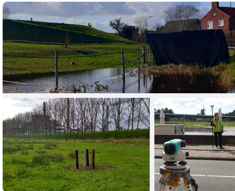
Figuur 2: Boven: Kwel door de dijk en de ondergrond: natte voeten zonder overstroming (Foto door Waterschap Rivierenland). Onder: Peilbuis die in de bodem wordt geplaatst om de grondwaterstand te meten (Foto door Waterschap Brabantse Delta) en veldwerk voor dataverzameling (Foto door Bas van der Meulen).
