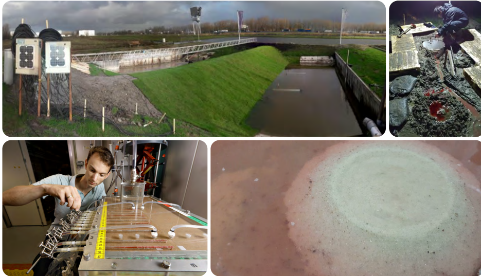
Piping-experimenten. Linksboven: proef op grote schaal in de Flood Proof Holland proefpolder bij de TU Delft. Rechtsboven: metingen tijdens de proef op grote schaal. Rechtsonder: zandmeeverende wel in de proef op grote schaal. Linksonder: experimenten op kleine schaal. Foto © Sam Rentmeester.
