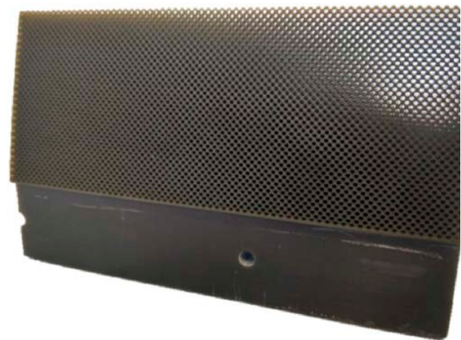
FIGUUR 4D: DETAIL VAN HET "3D-PRINTED PERMEABLE INSERT"
