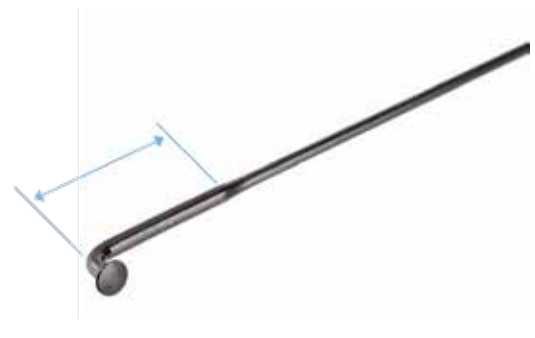
Afbeelding 2 Een 'double-butted' spaak - vanwege spanningsconcentraties en vermoeiing.
