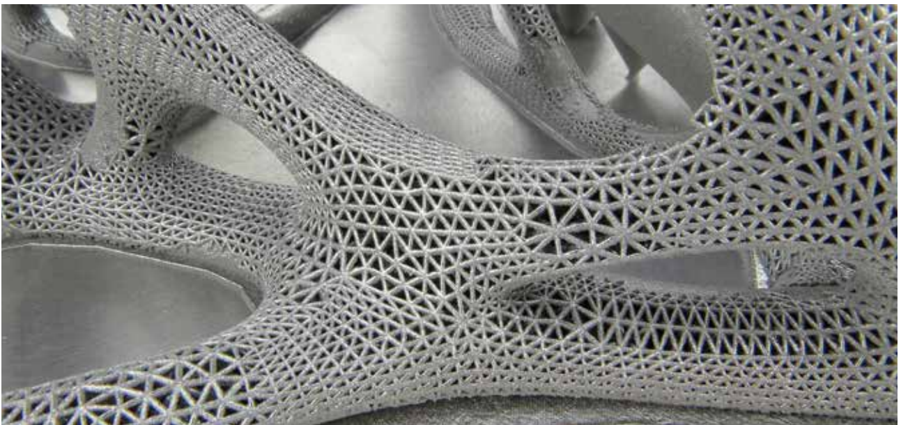
Afbeelding 8 Een ge3Dprint onderdeel ('spider bracket'). Materiaal wordt constructie – en omgekeerd. (Foto: Renishaw)
