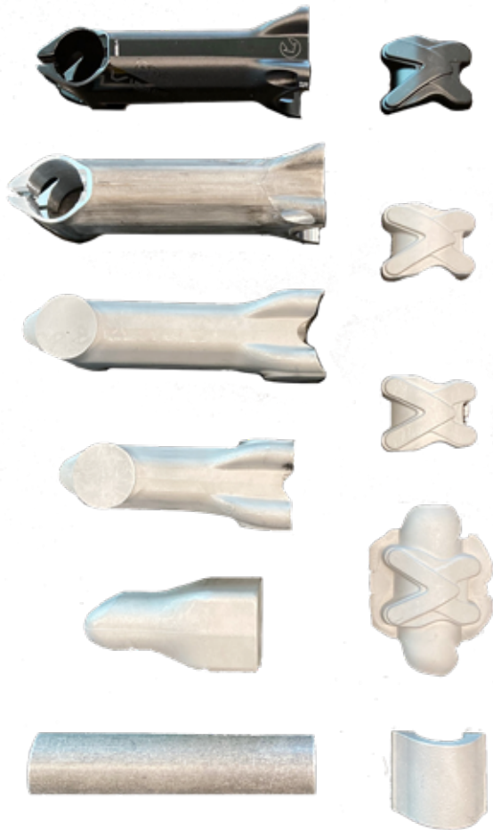
Afbeelding 4 het stapsgewijze smeden van een stuurpen (Bron: Shimano Europe)
