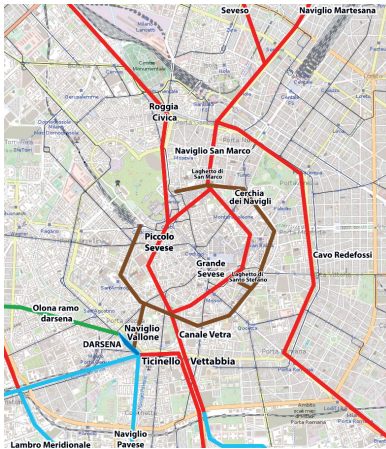
Huidige toestand kanalen in Milaan: blauw = open, bruin = gedeemt, rood = afgedekt, groen = droog
