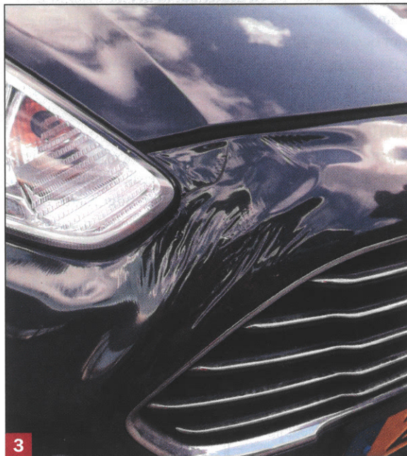
Door warmte vervormd front van auto
