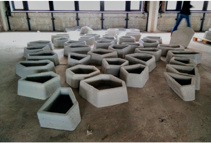
Afbeelding 5 Case Green Dome, 3D betonprinten en parametrisch ontwerpen.
