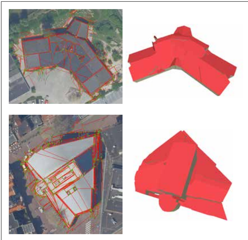
Figuur 13. 3D BAG-pand (rechts), gereconstrueerd op basis van gedetecteerde daklijnen uit true-ortho luchtfoto (links) en puntenwolken uit luchtfoto's.
