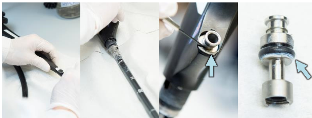
Figuur 64: (v.l.n.r.) Speksteenpoeder wordt aangebracht om de distale manchet van het bedieningshuis over de insertietube te kunnen schuiven; Onder de distale manchet komt geen Olympus naammerk tevoorschijn, insertietube is niet origineel; Waterdruppels onder de rubber ring van de ingang van het afzuig-/biopsiekanaal in het bedieningshuis; Ingangsventiel met O-ring voorzien van op siliconengel gelijkend materiaal.
