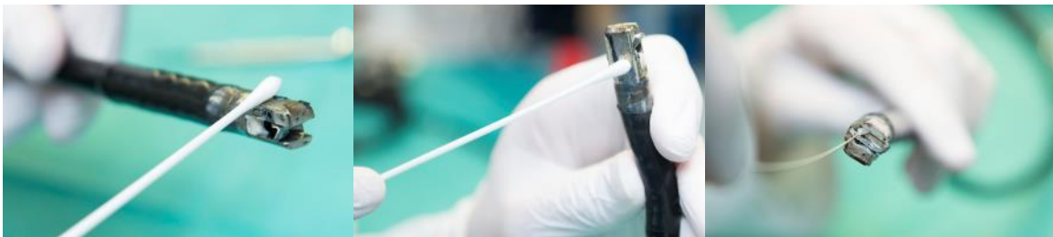
Figuur 39: (v.l.n.r.) Bemonstering tipdelen onder de kap {14}; Bemonstering onder de kap {15}; Bemonstering tangenliftruimte {16}.
