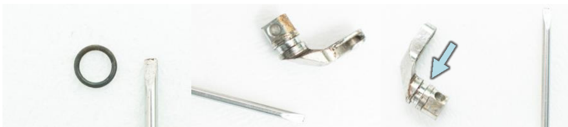
Figuur 44: (v.l.n.r.) O-ring naast schroevendraaier van 1mm diameter; Hefboom met hef-as naast schroevendraaier van 1mm diameter; Hefboom met bruine aanslag in O-ringgroef van hef-as.
