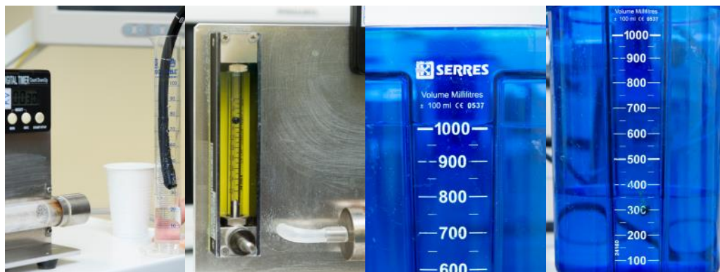
Figuur 11: (v.l.n.r.) Meting waterdebiet na 30 seconden; Luchtdebietmeting; Startvolume afzuigdebiet water; Restant volume water na 30 seconden afzuigen.
