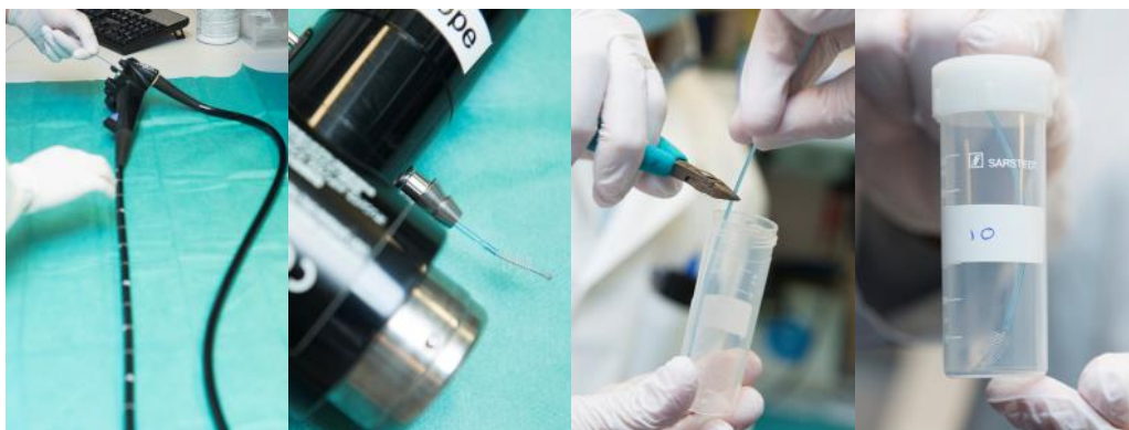
Figuur 31: (v.l.n.r.) Bemonstering afzuig-/biopsiekanaal...; tot de ingang bij de connector; Afknippen rager; Opslag monster {10}
