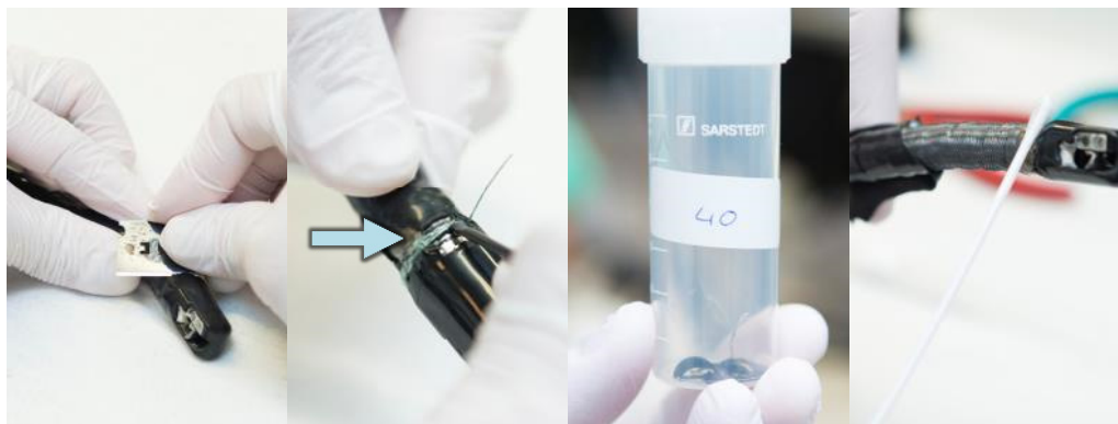
Figuur 56: (v.l.n.r.) Lossnijden van de voorste verlijming van het cardanrubber. Groene draad onder de voorste verlijming van het cardanrubber; Opgeslagen delen verlijming {40}; Bemonsteren onder de voorste verlijming van het cardanrubber en onder het cardanrubber.
