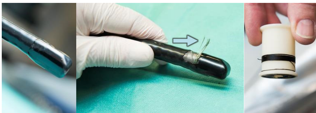
Figuur 37: (v.l.n.r.) Deuk in de tipkap; Groene draad onder voorste verlijming cardanrubber; Originele zwarte draad die door Olympus wordt gebruikt voor de verlijmingen.
