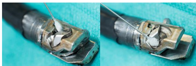
Figuur 41: (v.l.n.r.) Bemonsteren in de aandrijfruimte met tangenlift deels omhoog {20}; Bemonsteren in de aandrijfruimte met tangenlift helemaal omhoog {20};
