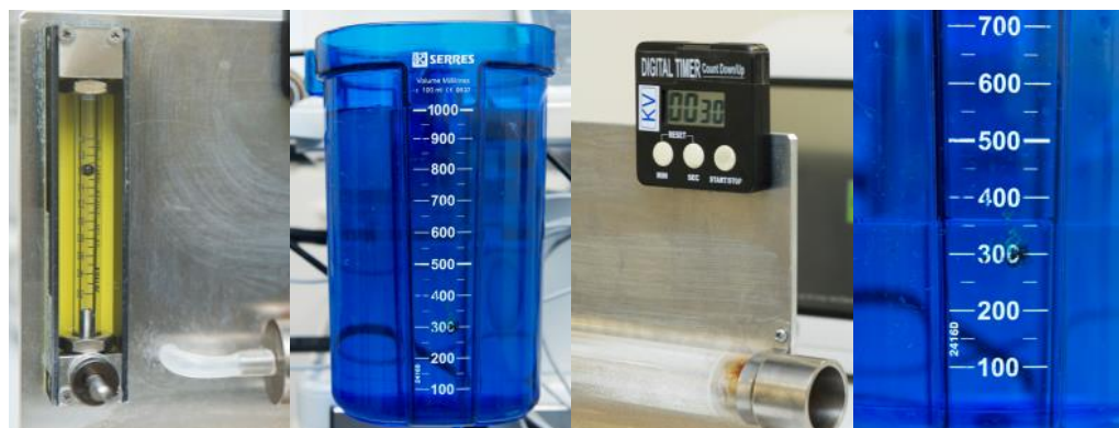
Figuur 6: (v.l.n.r.) Luchtdebietmeting; Startvolume afzuigdebiet water; Timer eindmeting afzuigdebiet water; Restant volume water na 30 seconden afzuigen.
