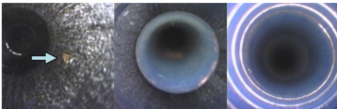
Figuur 36: Borescoopbeelden. (v.l.n.r.) Bruine aanslag bij ingang afzuig-/biopsiekanaal; Overgang ingang afzuig-/biopsiekanaal naar gladde buis afzuig-/biopsiekanaal; Overgang geribbelde buis afzuig-/biopsiekanaal naar gladde buis afzuig-/biopsiekanaal, gezien vanaf de bedieningshuuszijde richting de tip.
