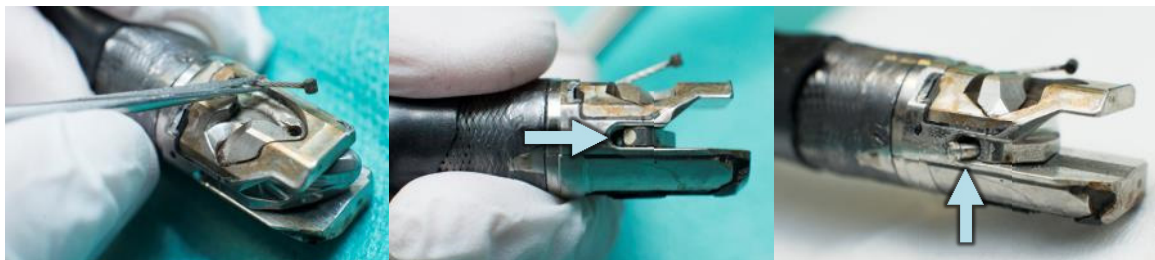
Figuur 42: (v.l.n.r.) Loshalen aandrijfkabel; Witte lijm op de schroef waarmee de tangenlift op de hef-as is bevestigd; Losgehaalde schroef met bruine aanslag op de schroefdraad.
