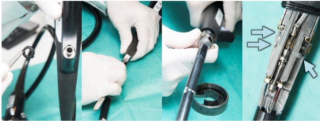
Figuur 47: (v.l.n.r.) Rubber ring losgehaald van ingang afzuig-/biopsiekanaal; Proximale manchet insertietube voorzien van speksteenpoeder voor het loshalen; Onder distale manchet geen Olympus naammerk op insertietube, insertietube is niet origineel; Binnenzijde bedieningshuis, waarin schroeven te zien zijn zonder verlijming.
