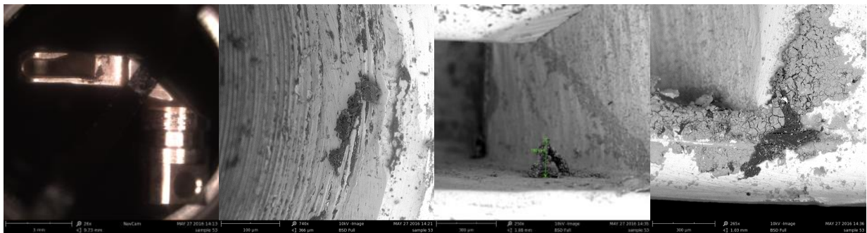
Figuur G08: (v.l.n.r.) Hefboom met hef-as Scoop B; Detailscan (740x). Bruine aanslag in schroefgat hef-as; Detailscan (250x). Opeenpakking van materiaal in hefboom. Lijkt visueel op oxidatieproducten zoals deze ontstaan in aanwezigheid van bacteriën; Detailscan (340x). Opgedroogd, poederachtig materiaal op de hefboom.
