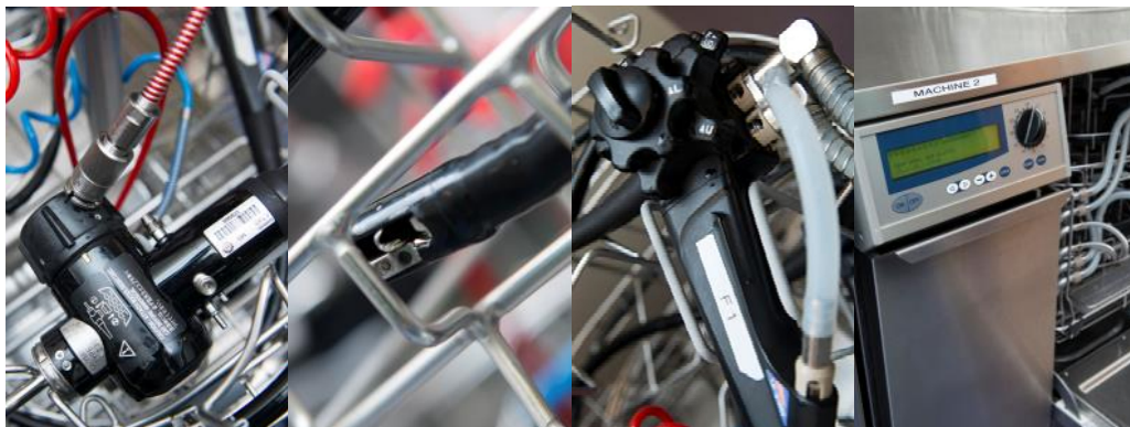
Figuur 22: (v.l.n.r.) Scoop B met afgedopte connector in de ETD3; Tangenlift van Scoop B 45 graden omhoog gezet; Scoop B aangesloten aan bedieningshuiszijde in ETD3; ETD3 met daarin Scoop A en Scoop B, klaar om het machinale desinfectieproces te starten.
