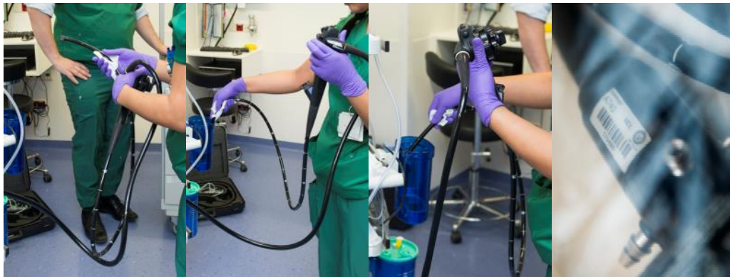
Figuur 12: (v.l.n.r.) Afnemen Scoop A met gaasjes; Spoelen Scoop A met water; Doorblazen Scoop A met lucht; Scoop A in de schone transportbak.
