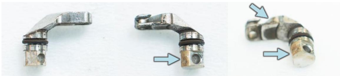
Figuur 43: (v.l.n.r.) Hefboom met hef-as en O-ring; Bruine aanslag op hef-as en beide zijden O-ring; Bruine aanslag op hef-as en hefboom op meerdere oppervlakken.
