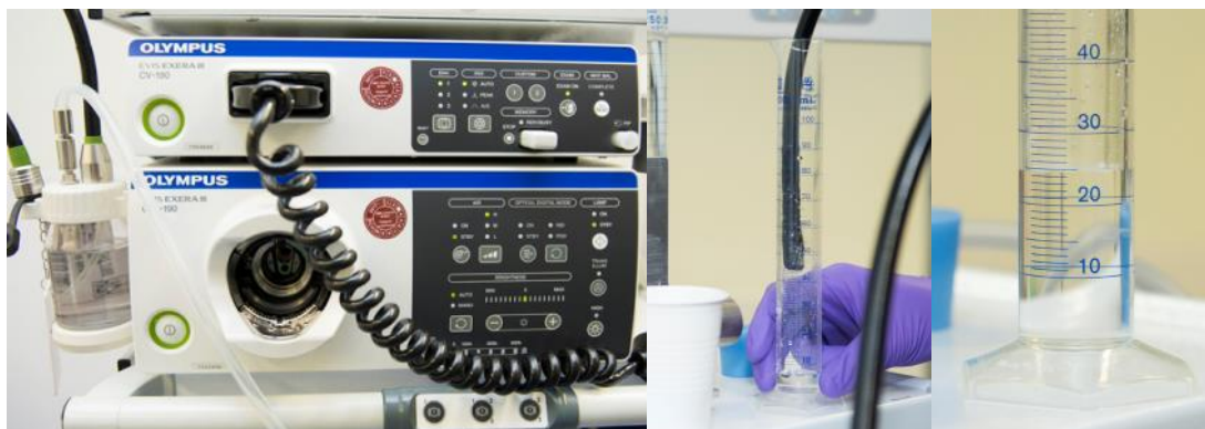
Figuur 5: (v.l.n.r.) Gebruikte lichtbron; Opvangen water van waterdebietmeting; Doorgespoeld water na 30 seconden.
