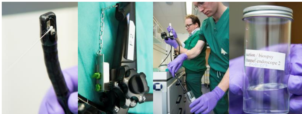
Figuur 8: (v.l.n.r.) Tangenliftruimte bemonsteren met pernasale droge wattenstaaf; Afsluiting van de kanalen; Doorspoelen afzuig-/biopsiekanaal; Opslag spoelmonster Olympus {suction/biopsy channel endoscope 2}.
