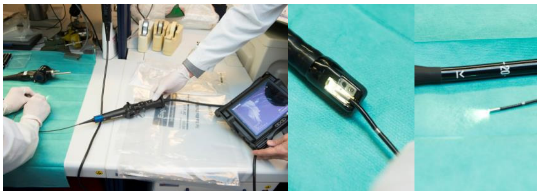
Figuur 34: (v.l.n.r.) Afzuig-/biopsiekanaalinspectie met borescoop; Tip van de borescoop in de tangenliftruumte; Referentiefoto waarop te zien is tot hoever de borescoop vanaf de tipzijde van Scoop A was ingebracht.
