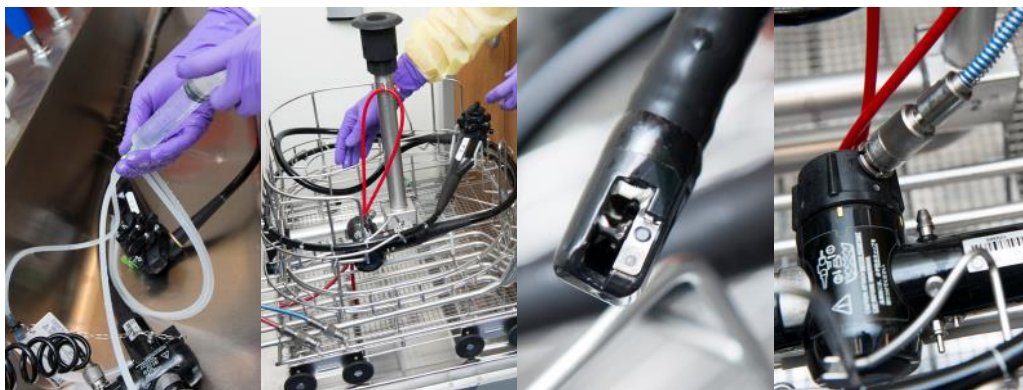
Figuur 17: (v.l.n.r.) Kanalen doorspuiten met water (3x30ml) en lucht; Scoop A in de ETD3; Scoop A in de ETD3 met de tangenlift onder 45 graden; Scoop A afgedopt bij de connector in de ETD3.
