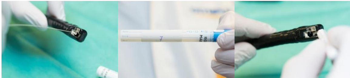
Figuur 29: (v.l.n.r.) Bemonstering tip {7}; Opslag monster {7}; Bemonstering {8} met de MAJ-1888 borstel.
