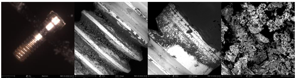
Figuur G03: (v.l.n.r.) Schroef tangenlift Scoop A; Detailscan (255x). Poederachtig, bruin materiaal in schroefdraad; Detailscan (255x). Poederachtige bruine aanslag op schroefhals; Detailscan (3600x). Poederachtige bruine aanslag met organische kenmerken.
