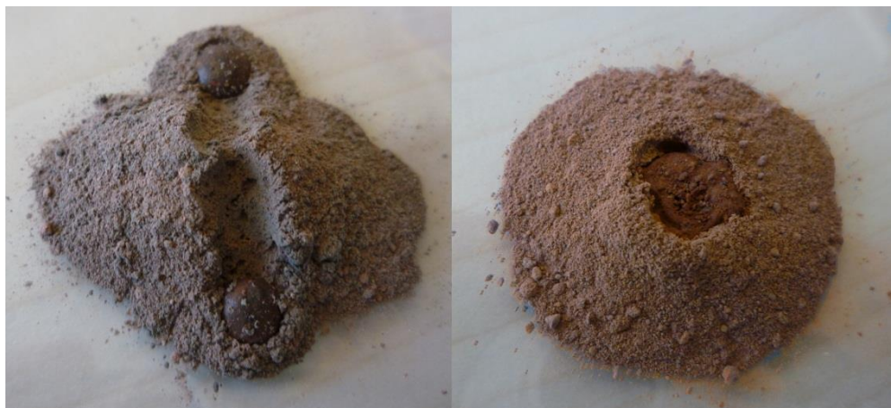
Fig. 9. Monsters met (links) en zonder (rechts) duidelijk waterafstotende eigenschappen.
