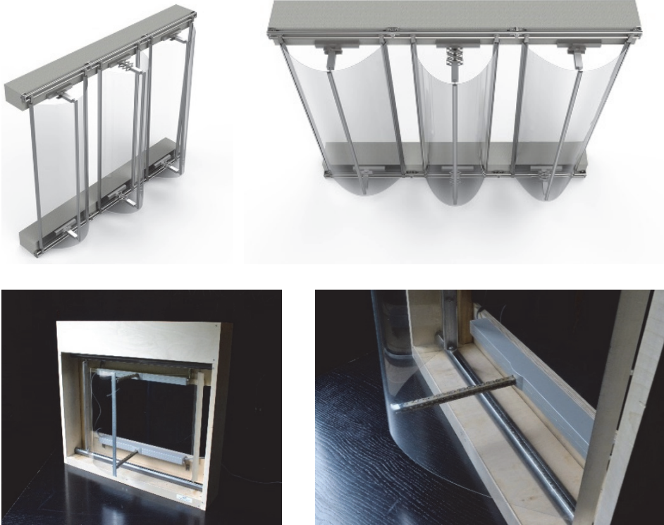
Bild 2-1 Entwurf und Mock-up der vorgeschlagenen adaptiven Dünnglassassade; Masterprojekt von Ribeiro Silveira [8].
