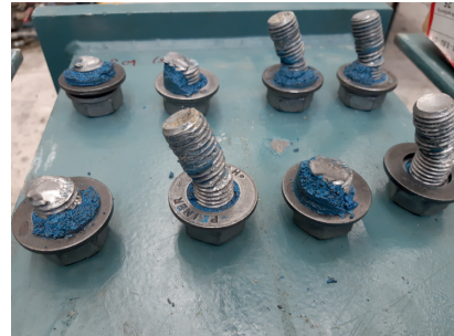
(d) Injection bolts after testing.
