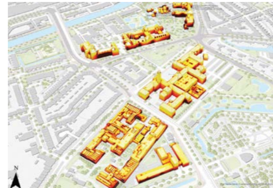
Figuur 5: Zonnepotentieel van Bouwkunde en omliggende gebouwen: de daken van Bouwkunde zijn bijzonder geschikt voor een hoge elektriciteitsopbrengst [Zhou et al. 2021]
